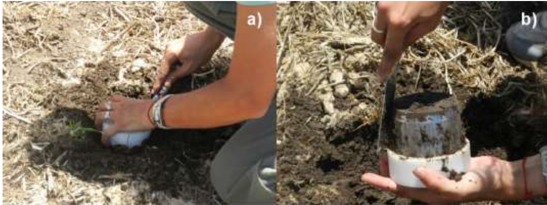
Figura 2.3.1. Secuencia de extracción de muestras de suelo para medir densidad aparente en dos profundidades (0-5 cm y 10-15 cm).
