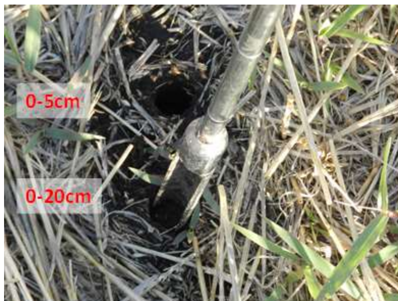
Figura 2.4.1. Muestreo de materia orgánica y nutrientes a dos profundidades (0-5 cm y 0-20 cm).
